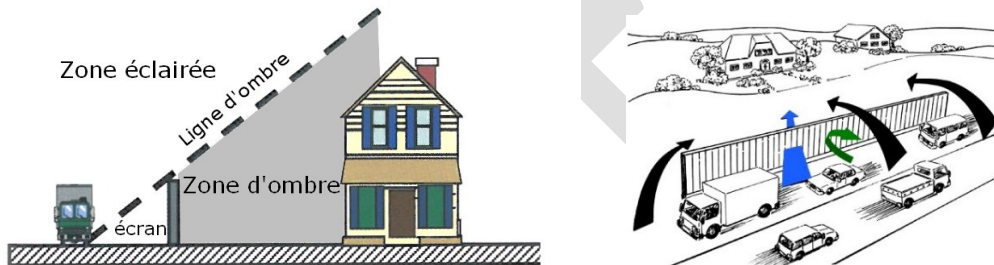
Figure 10: Effet d'obstacle - Source : Guide Les écrans acoustiques CERTU
