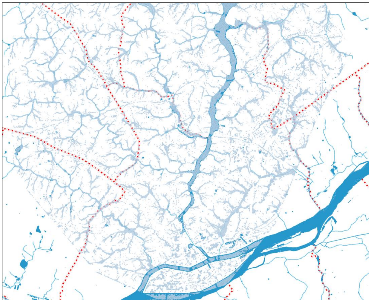
Figure n° 12 Résultats d'un premier test de simulation des écoulements sur le sous bassin versant de l'Erdre
