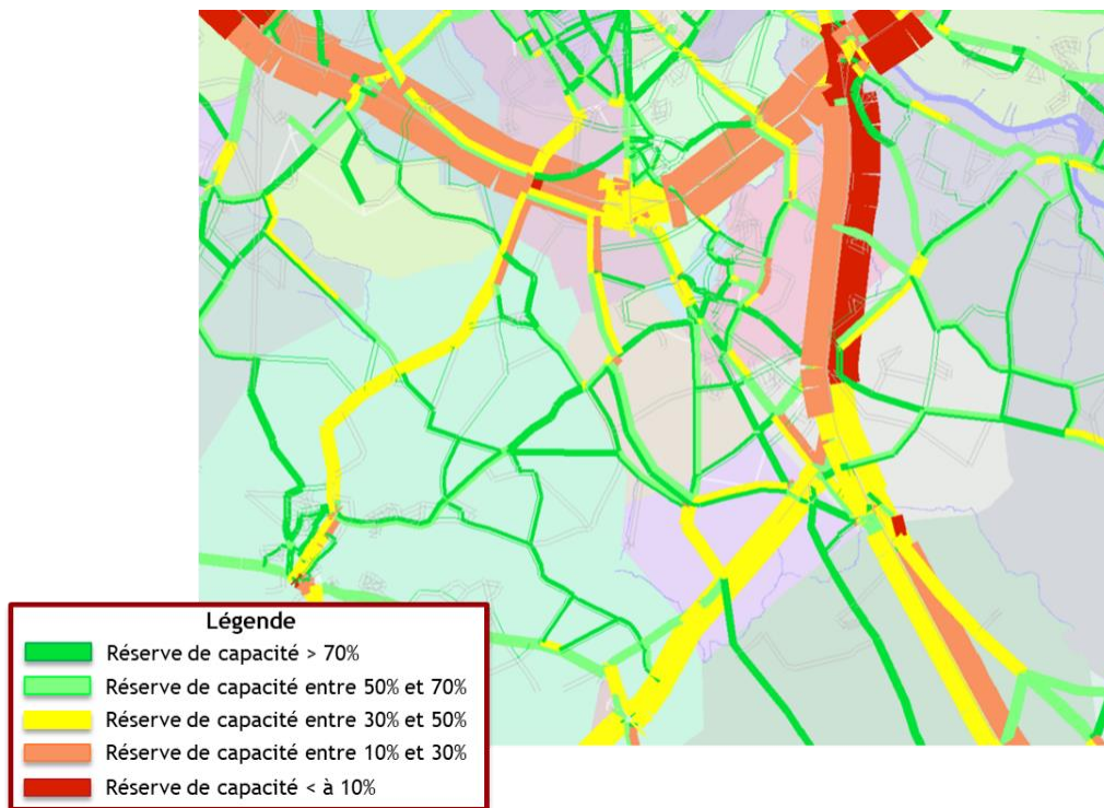
Figure 57 : Scénario 3 - Trafic VP et réserves de capacité - Heure de pointe du matin - Horizon 2035
