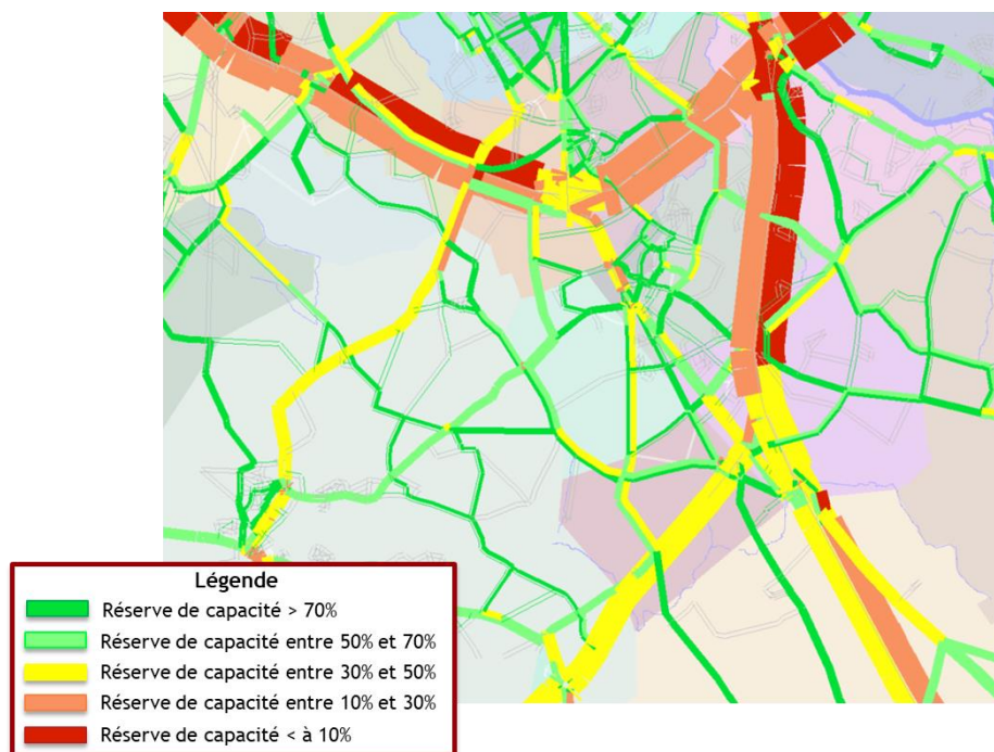
Figure 47 : Scénario 1 - Trafic VP et réserves de capacité - Heure de pointe du matin - Horizon 2035
